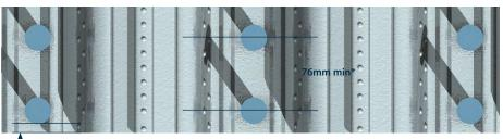
20mm min., edge of stud to edge of beam
